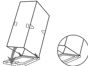
4. Alinee la caja de plástico con la ranura dentro de la tapa trasera y presiónela completamente hacia abajo.
